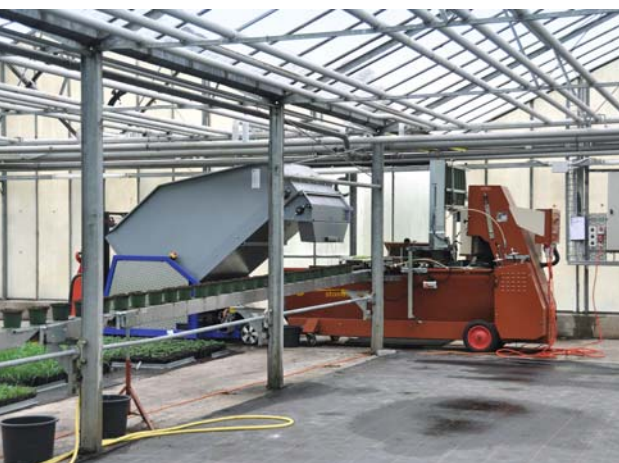
Die Stauden werden mit Förderbändern von der Topfmaschine direkt zu den Stellflächen transportiert.
